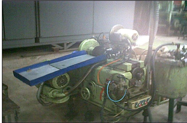
รูปที่ 3.15 เครื่องปั่นทากาวท้ายหลอด
