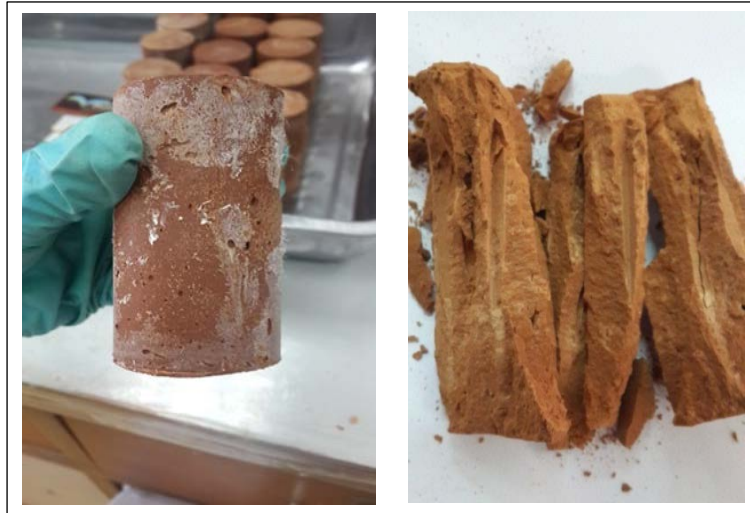
รูปที่ 4.3 ก้อนจีโอพอลิเมอร์ที่มีผลึก โซเดียมคาร์บอเนตเกาะบริเวณผิวก้อนตัวอย่าง
