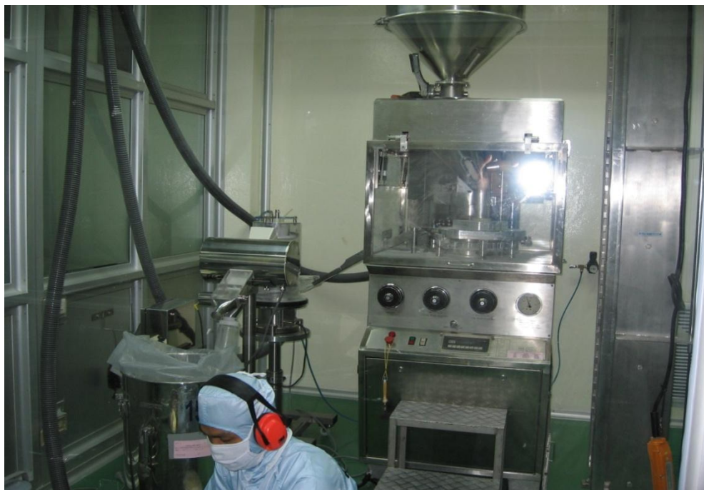
รูปที่ 3.7 เครื่องตอกอัดเม็ดยา และเครื่อง Metal detector
