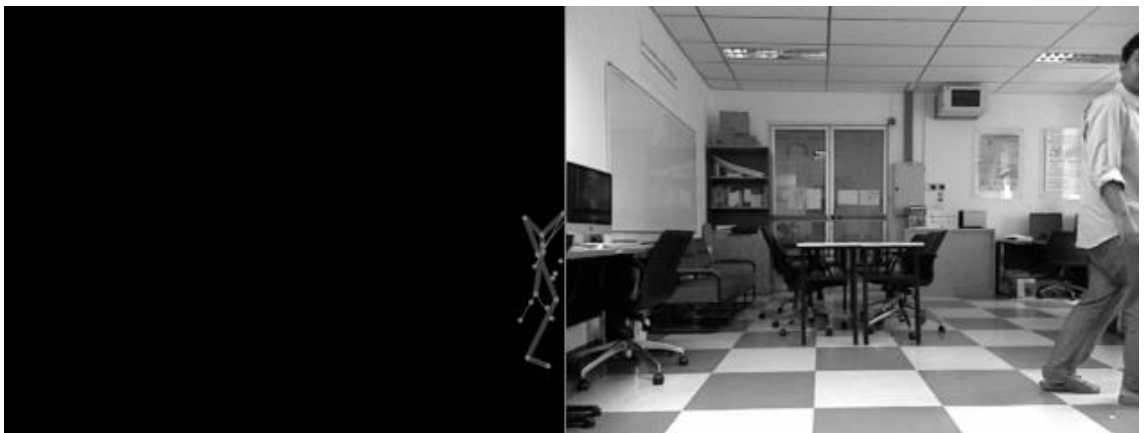
รูปที่ 3.3.2 การวิเคราะห์ท่าทางที่ผิดพลาดของกล้อง Kinect ซึ่งเกิดในช่วงที่ผู้ร่วมการทดลองกำลังเดินออกจากฉากรับภาพ
