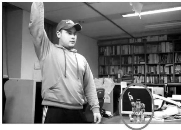
รูปที่ 2.11 ระบบการควบคุมหุ่นยนต์โดยใช้กล้อง Kinect ในการตรวจจับท่าทางของผู้ควบคุม [33]
