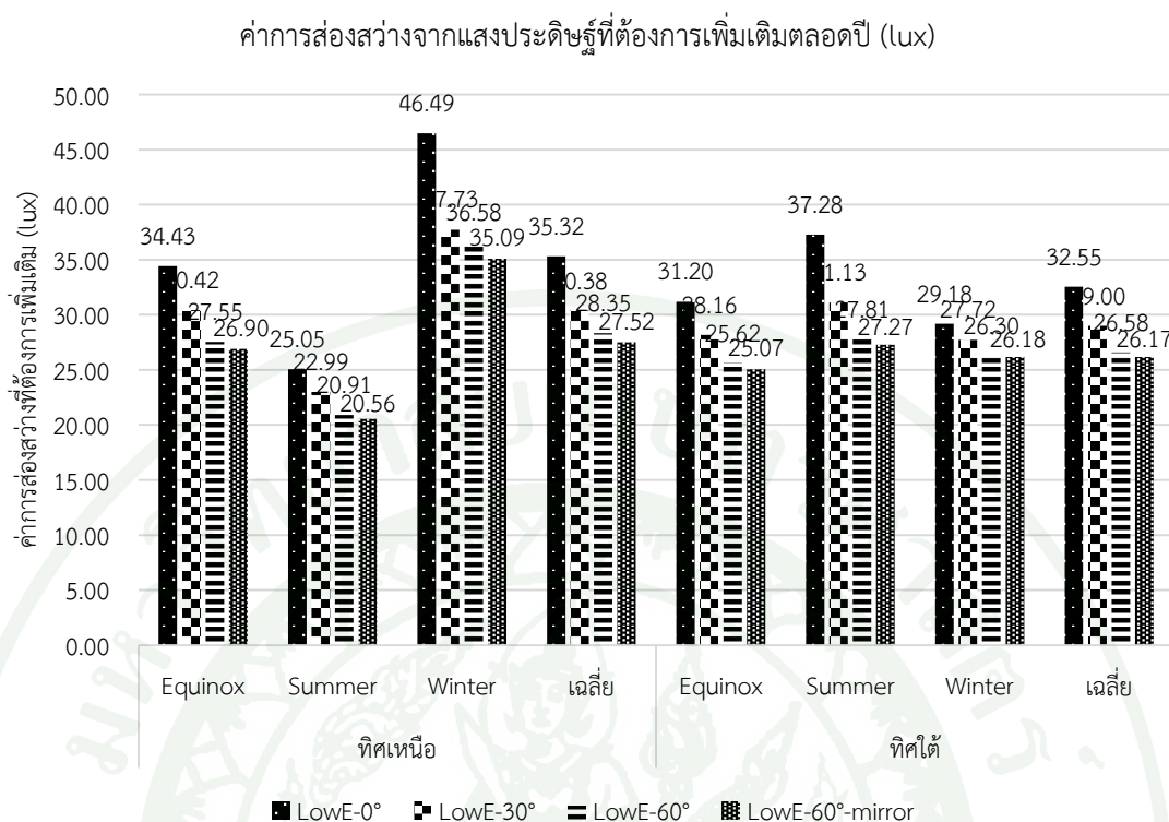
ภาพที่ 51 การเปรียบเทียบค่าการส่องสว่างจากแสงประดิษฐ์ที่ต้องการเพิ่มเติม (lux) ของห้องพักในโรงแรมในทิศเหนือและทิศใต้จากการใช้แผงกันแดดแบบหึ่งแสง 4 รูปแบบ
