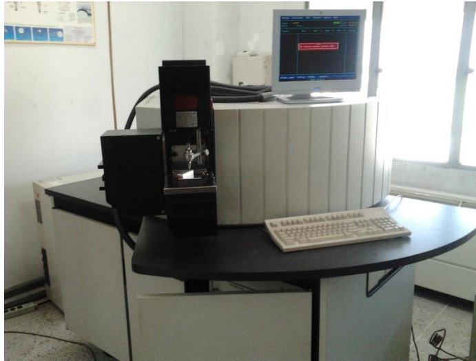
รูปที่ ค.1 การทดสอบส่วนผสมทางเคมี
