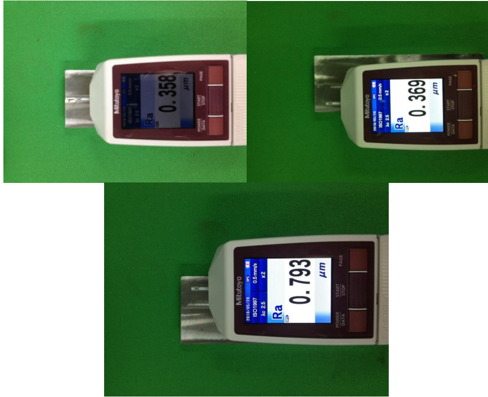
รูปที่ ค.11 การวัดค่าความเรียบผิวงานตำแหน่งที่ 3
