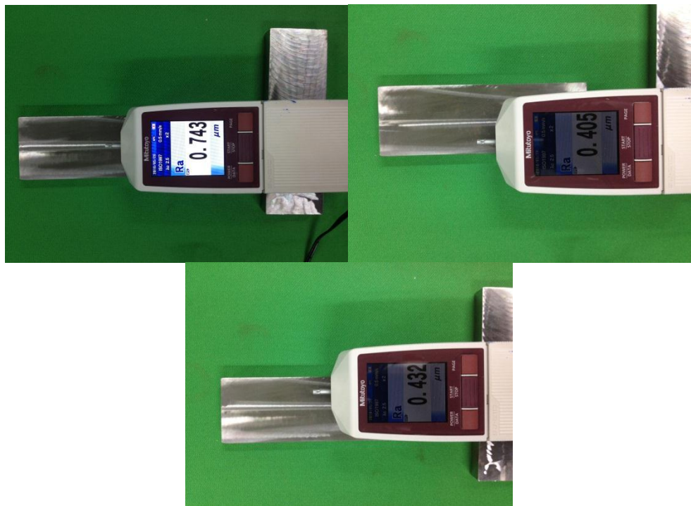
รูปที่ ค.10 การวัดค่าความเรียบผิวงานตำแหน่งที่ 2
