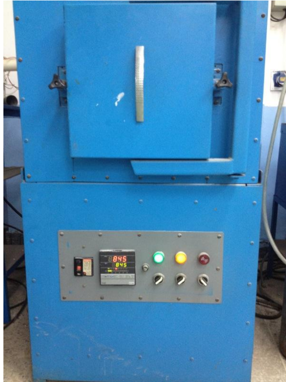
รูปที่ ค.3 นำชิ้นงานเข้าเตาอบไฟฟ้าเพื่อทำการชุบแข็ง
