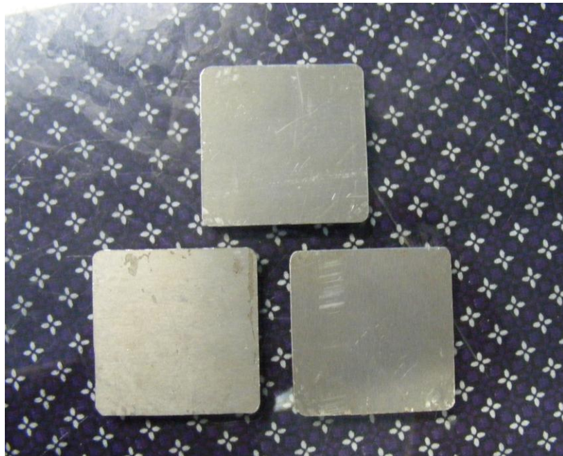
รูปที่ ค.1 เตรียมชิ้นงานอลูมิเนียมผสม A6061 ขนาด 40x40x3 มิลลิเมตร
