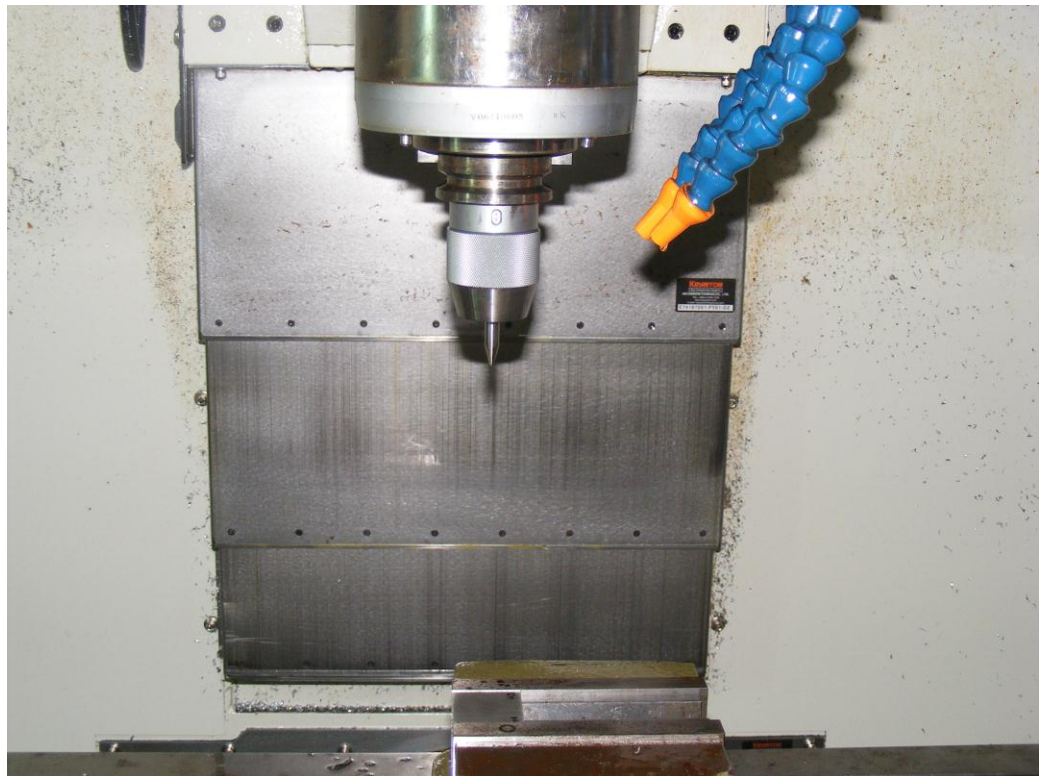
รูปที่ ค.6 จับชิ้นงานและดอกเจาะ Hss. แต่งกลมทดลองเจาะอัตราส่วนพื้นที่สัมผัส 50%, 75%, 100%
