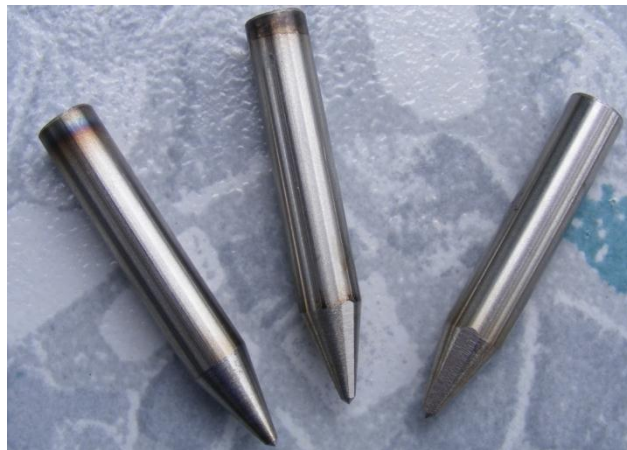
รูปที่ ค.2 ถัดดอกเจาะ Hss. เกรด 1900 มุม 90 องศา อัตราส่วนลัมผัส 50%,75%,100%
