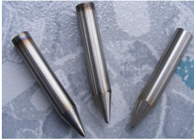
รูปที่ 3.7 แสดงรูปร่างดอกเจาะจริง
