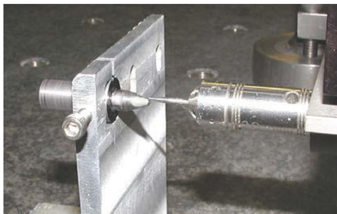
รูปที่ 2.6 (ต่อ) รูปภาพการวัดส่วนต่างของดอกเจาะ[12]
