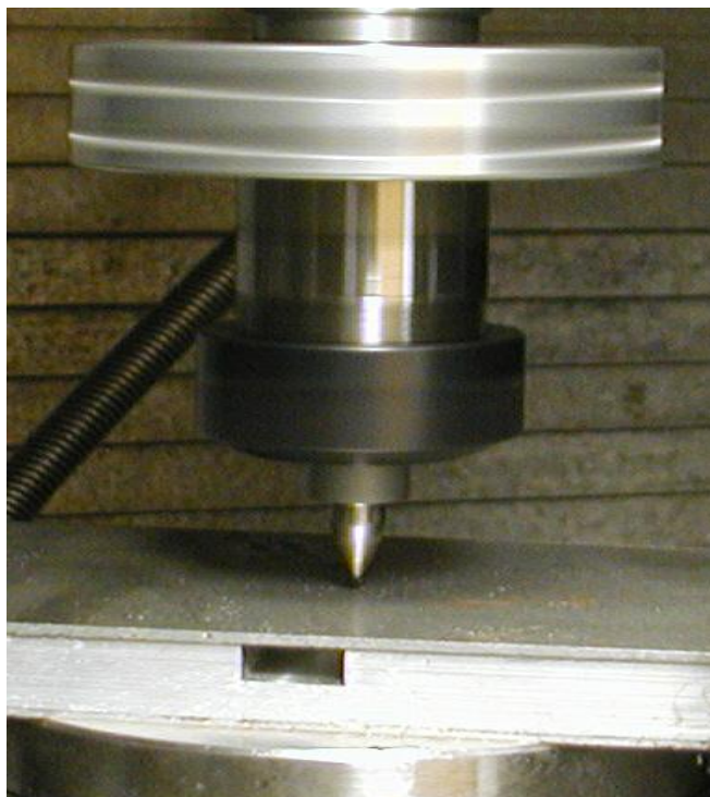
รูปที่ 2.4 รูปการหมุนเจาะชิ้นงาน [11]
