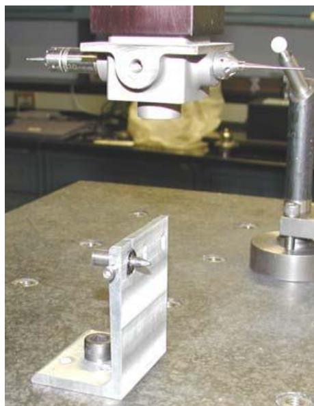
รูปที่ 2.6 รูปภาพการวัดส่วนต่างของดอกเจาะ[12]
