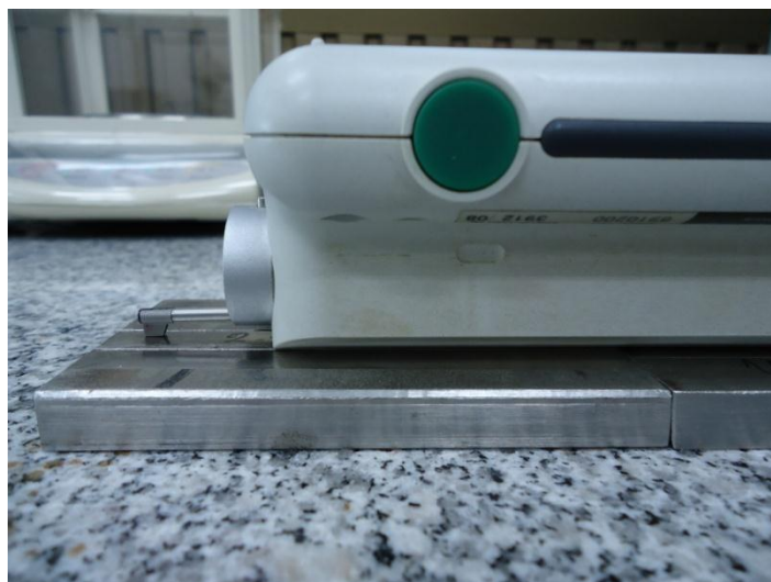
รูปที่ ค.4 ภาพการใช้วัดความเรียบผิวงาน
