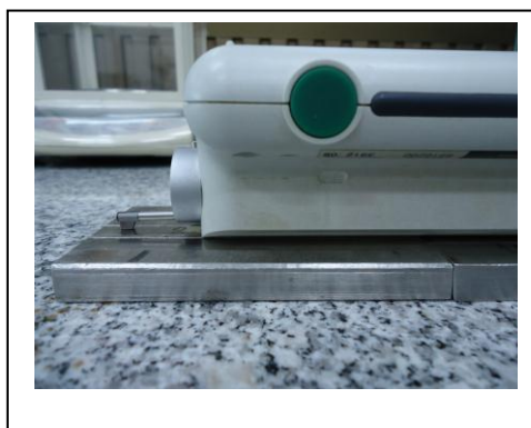
รูปที่ ก.8 การวัดความเรียบผิวของชิ้นงานที่ผ่านขบวนการกัด
