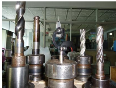
รูปที่ 3.6 ตัวอย่างอุปกรณ์จับยึดเครื่องมือตัดสำหรับเครื่องกัดซีเอ็นซีแบบต่างๆ
