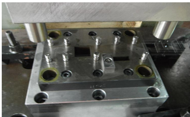
รูปที่ ข.5 ประกอบชุดแม่พิมพ์รูปทรงสี่เหลี่ยมเข้ากับเครื่อง Press
