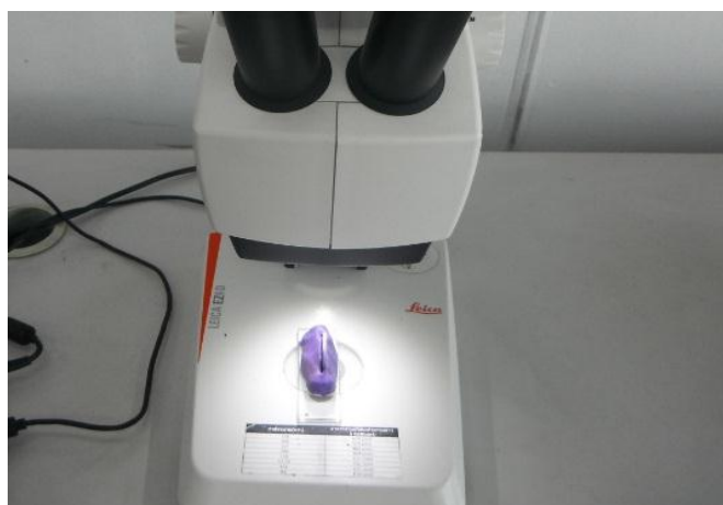
รูปที่ ข.14 ตรวจสอบขอบตัดชิ้นงานด้วยกล้องจุลทรรศน์
