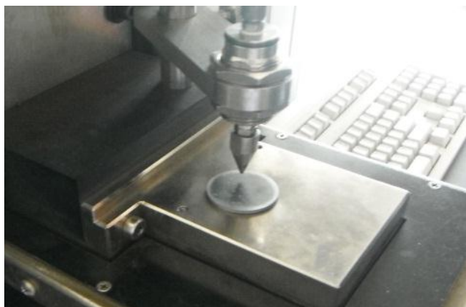
รูปที่ ข.11 ทดสอบหาส่วนผสมทางเคมีเหล็กกล้าคาร์บอน S10C
