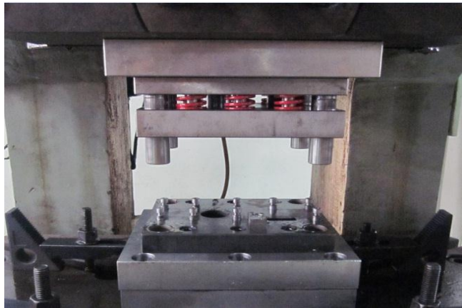
รูปที่ ข.4 ประกอบชุดแม่พิมพ์รูปทรงกลมเข้ากับเครื่อง Press
