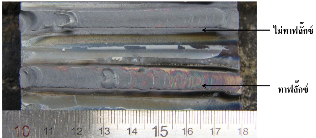
รูปที่ ก.5 Si-200 ลักษณะของแนวเชื่อมทافلิกซ์ Silica Oxide ( \text{SiO}_2 ) กระแส 200 แอมแปร์
