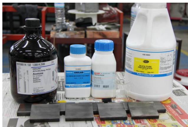
รูปที่ 3.5 ฟลักซ์ 3 ชนิด คือ Titanium Oxide ( \text{TiO}_2 ) Silica Oxide ( \text{SiO}_2 ) และ Aluminium Oxide ( \text{Al}_2\text{O}_3 )
