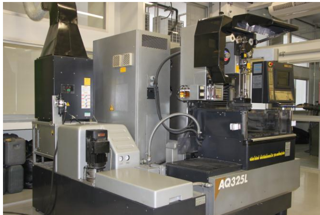
รูปที่ 3.3 Wire Cut Machines (AQ325L)
