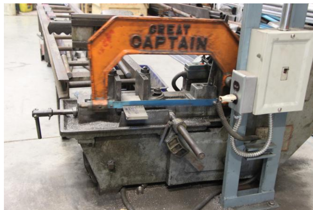
รูปที่ 3.4 เครื่องเลื่อยกล รุ่น MEBA 320
