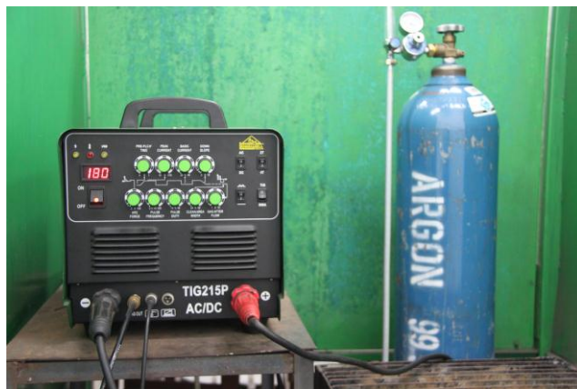
รูปที่ 3.1 เครื่องเชื่อมทิก เอช.ดี.ซี. TIG 215P AC/DC
