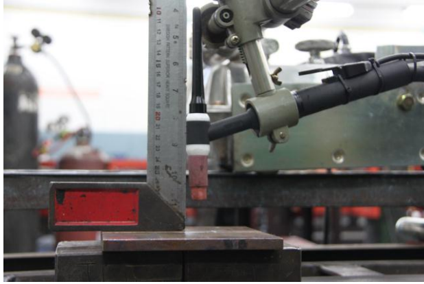
รูปที่ 3.6 แผ่นทองแดงรองหลังงานเชื่อมและการตั้งปลายหัวเชื่อม
