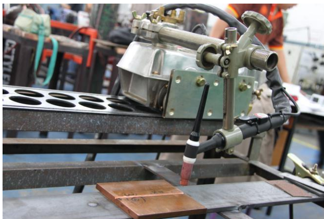
รูปที่ 3.2 เครื่องตัดแก๊สแบบเส้นตรงขับเคลื่อนด้วยมอเตอร์ TANATA KT-5N
