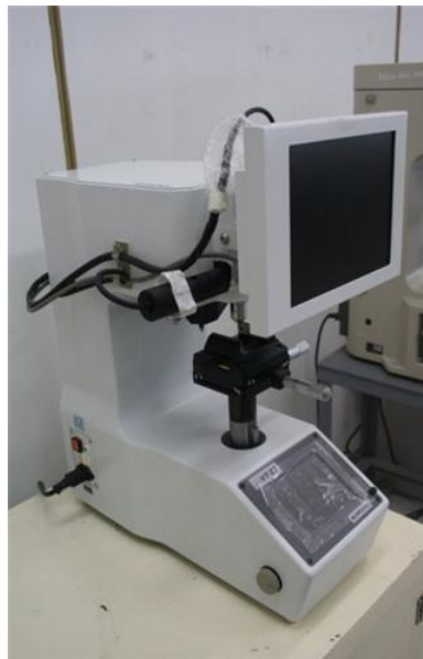
รูปที่ 3.7 เครื่องทดสอบความแข็ง (Micro Hardness Tester) รุ่น MATSUZAWA Model MMT-X7B
