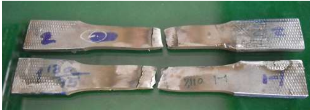
รูปที่ ค.5 รูปชิ้นงานที่ขาดเนื่องจากการทดสอบแรงดึง
