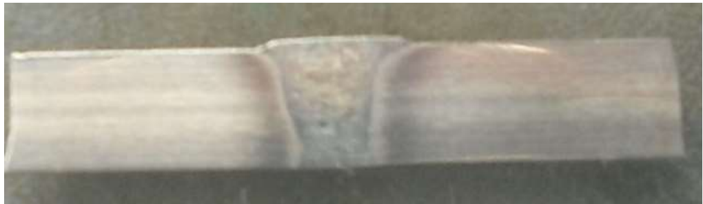
รูปที่ ค.6 รูปชิ้นงานที่มี Ultimate Tensile Strength สูงสุด
