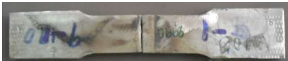
รูปที่ ค.4 รูปชิ้นงานที่ตัดด้วย Wire Cut เพื่อเตรียมทดสอบแรงดึง
