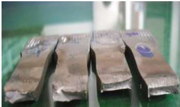
รูปที่ 3.23 ลักษณะภาคตัดของชิ้นงานที่ขาดจากกัน
