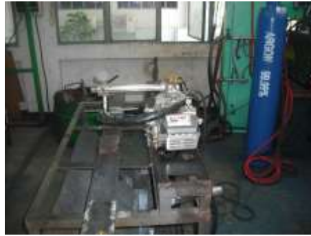
รูปที่ 3.2 เครื่องตัดแก๊สแบบเส้นตรงขับเคลื่อนด้วยมอเตอร์TANAKA รุ่น KT 5 NX
