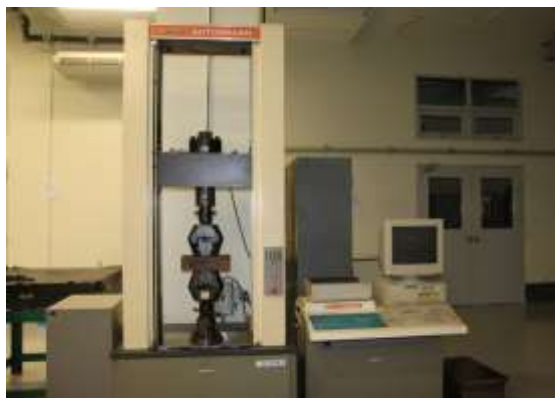
รูปที่ 3.6 เครื่องทดสอบแรงดึง AG – 25 TB
