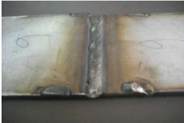
รูปที่ 3.19 ลักษณะงานที่เชื่อมเสร็จและปล่อยให้เย็นตัวในอากาศ
