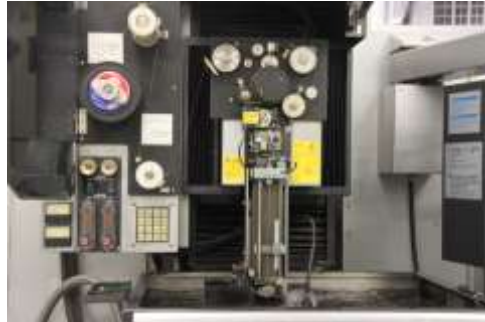
รูปที่ 3.20 การเตรียมชิ้นงานทดสอบแรงดึงด้วยเครื่อง Wire Cut
