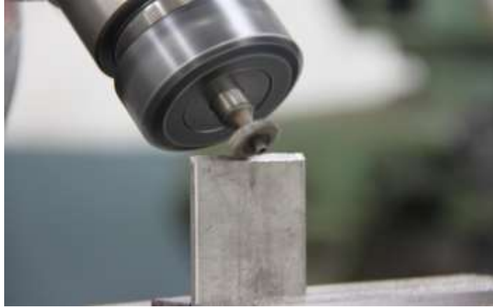
รูปที่ 3.12 แสดงการบากหน้างานมุม 15^\circ
