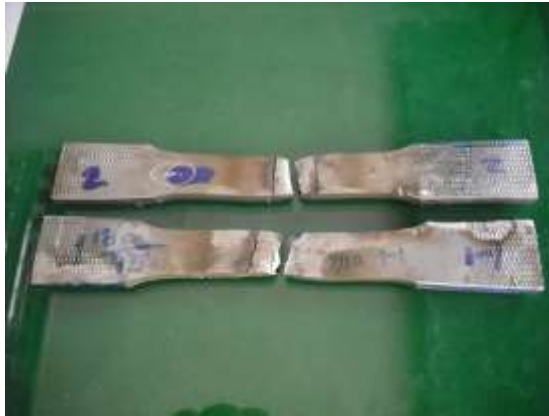
รูปที่ 3.22 รูปชิ้นงานทดสอบแรงดึงที่ขาดจากกัน
