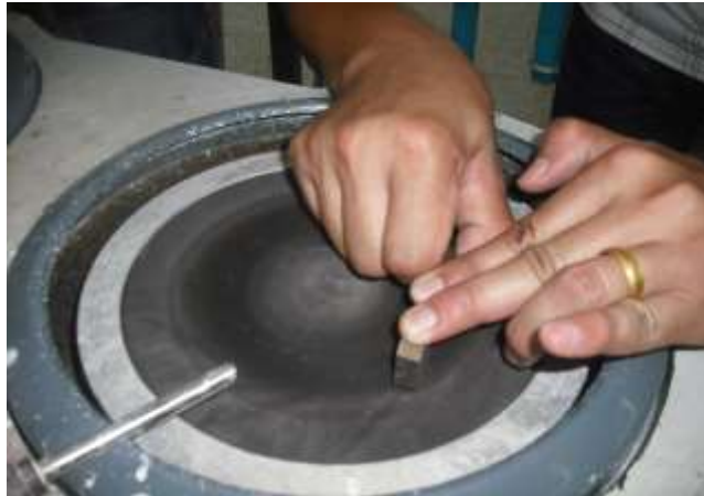
รูปที่ 3.24 แสดงการขัดชิ้นงานด้วยการดาษทราย
