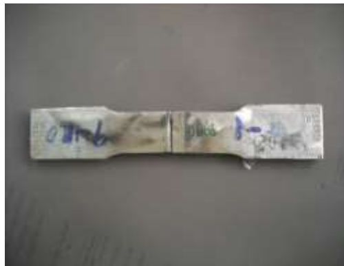
รูปที่ 3.21 รูปชิ้นงานเตรียมทดสอบแรงดึง
