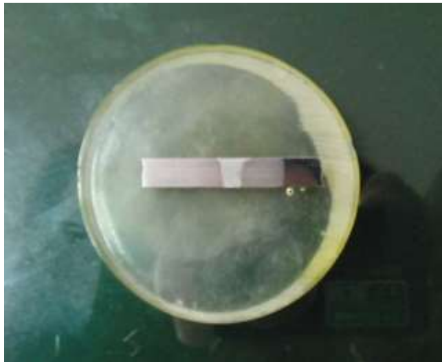
รูปที่ 3.25 ลักษณะชิ้นงานเมื่อกัดด้วยกรด
