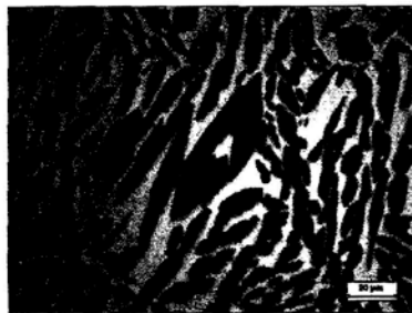
รูปที่ 8 บริเวณแนวเชื่อม (Welded) อบอ่อนที่อุณหภูมิ 850°C 5 ชั่วโมง
