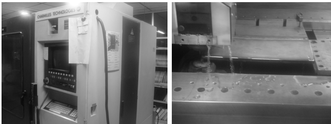
รูปที่ 3.5 การตัดชิ้นงานทดลองด้วยเครื่องตัด Wire-Cut
