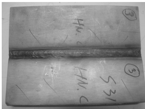
รูปที่ 3.3 ชิ้นงานทดลองเชื่อมบากร่องตัวด้วยกระบวนการเชื่อม TIG
