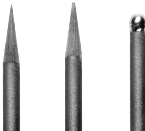
รูปที่ 2.16 แสดงปลายที่เจียรนัยแล้วของทั้งสแตนอเล็กโตรดในการเชื่อมแต่ละแบบ[10]
