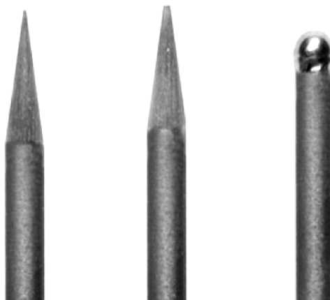
รูปที่ 2.16 แสดงปลายที่เจียรนัยแล้วของทั้งสแตนเลสในการเชื่อมแต่ละแบบ[10]
