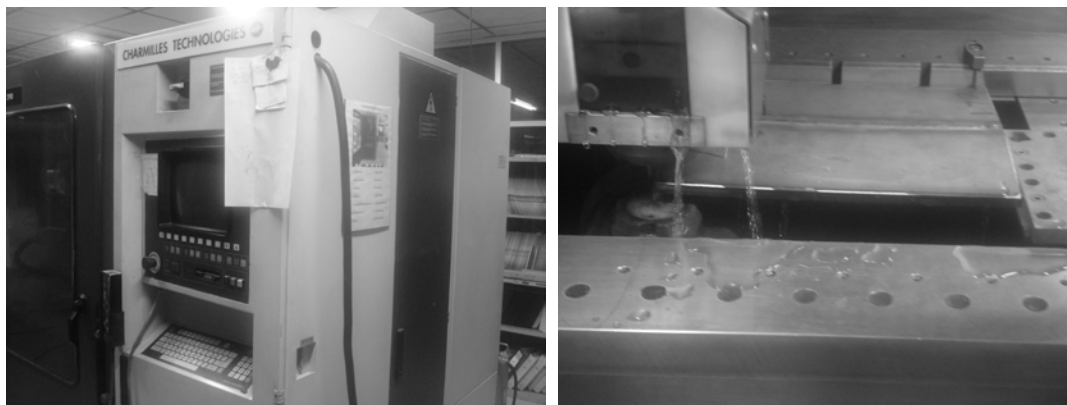
รูปที่ ค.4 แสดงการตัดชิ้นงานทดลองด้วยเครื่องตัด Wire-Cut
