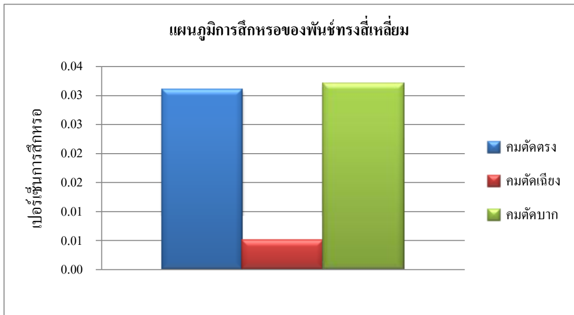
รูปที่ 4.4 แผนภูมิเปรียบเทียบเปอร์เซ็นต์การสึกหรอของฟันซี่ทรงสี่เหลี่ยม
