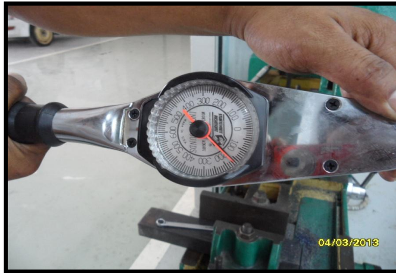
รูปที่ 3.18 แสดงค่าการขันตึงใบเลื่อยด้วยประแจปอนด์
