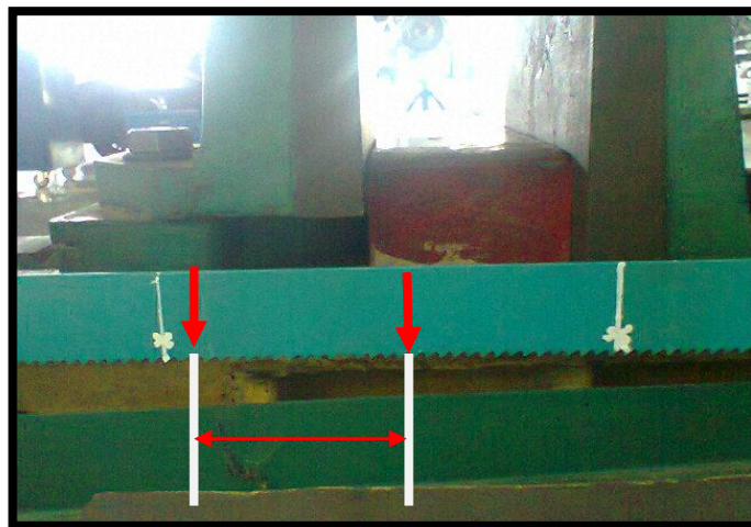
รูปที่ 3.9 แสดงการหาวิธีการวัดเลื่อยที่สัมผัสกับชิ้นงานจำนวน 19 ฟัน
