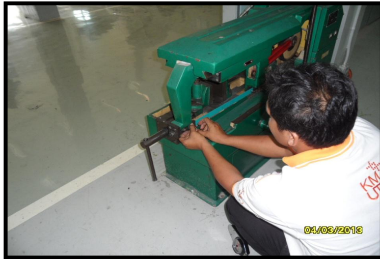
รูปที่ 3.16 แสดงการประกอบใบเลื่อยเข้ากับเครื่องเลื่อย
