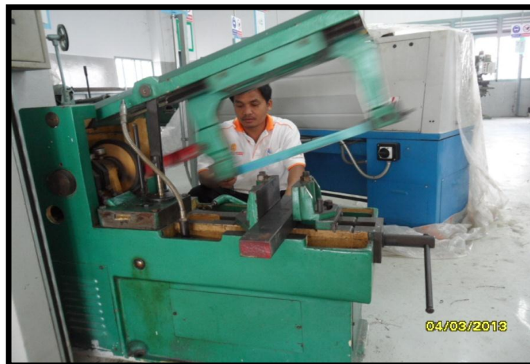
รูปที่ 3.17 แสดงการประกอบใบเลื่อยเข้ากับเครื่องเลื่อยและทดลองเลื่อย
