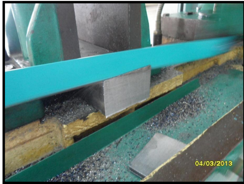
รูปที่ 4.1 การทดลองในเลื่อยที่ความเร็วช่วงชัก 77 ครั้งต่อนาที อัตราป้อน 0.2 มิลลิเมตรต่อครั้ง
