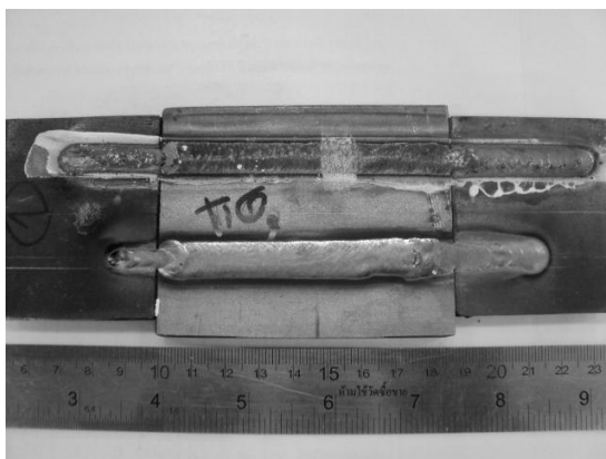
รูปที่ ข.7 แสดงชิ้นงานที่เชื่อมเสร็จแล้วของการทาฟลักซ์ไทเทเนียมออกไซด์
