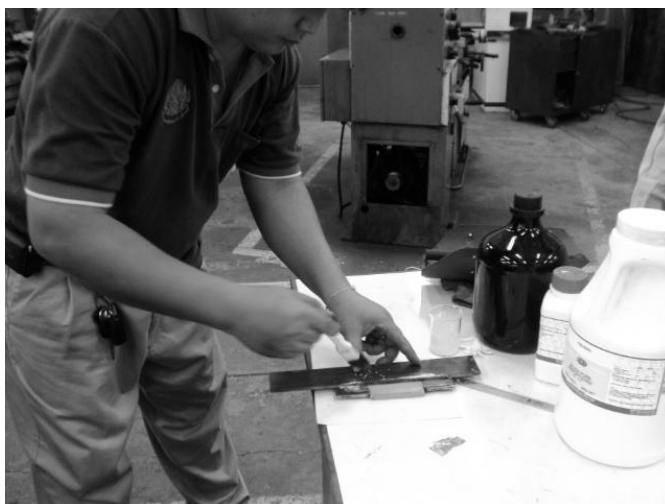
รูปที่ ข.4 แสดงการทาฟลักซ์ลงบนชิ้นงานทดลอง
