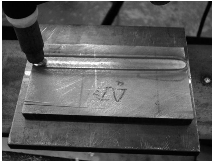
รูปที่ 3.1 ชิ้นงานเหล็กกล้าไร้สนิมออสเทนนิติก AISI 2205 ที่ใช้ในการทดลอง
