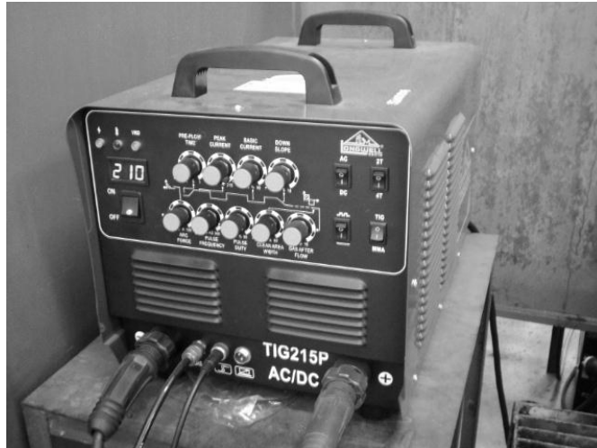
รูปที่ 3.5 เครื่องเชื่อมทิก Long well ขนาด 215 Amp
