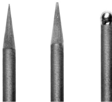
รูปที่ 2.11 แสดงปลายที่เจียรนัยแล้วของทั้งสแตนอเล็กโตรดในการเชื่อมแต่ละแบบ [ 8 ]
