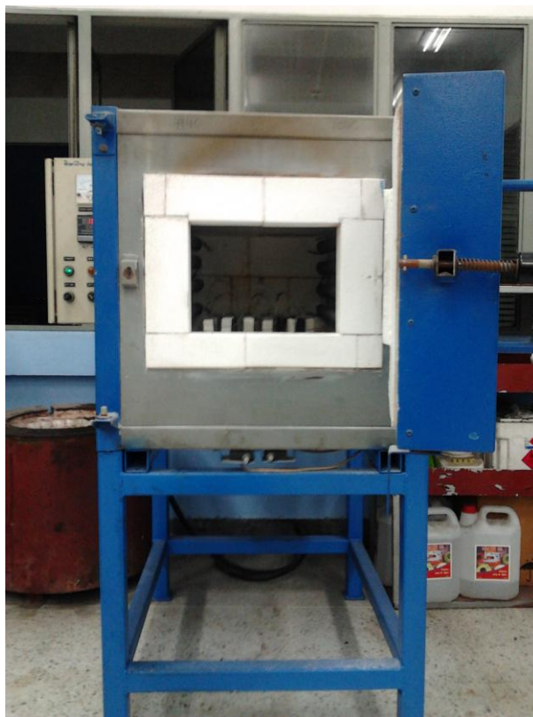
รูปที่ ค.4 นำชิ้นงานเข้าเตาอบไฟฟ้าเพื่อทำการบ่มแข็ง
