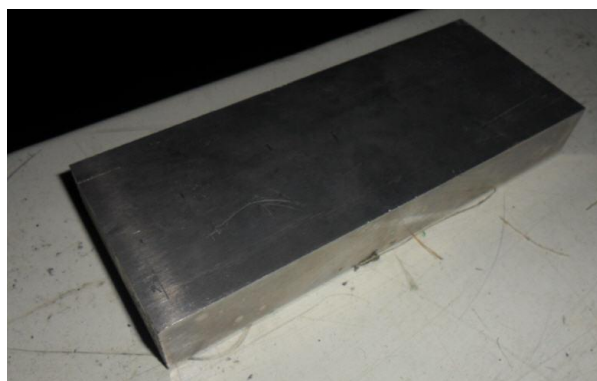
รูปที่ 3.8 แท่งอะลูมิเนียมผสมที่ผ่านการบ่มแข็ง
