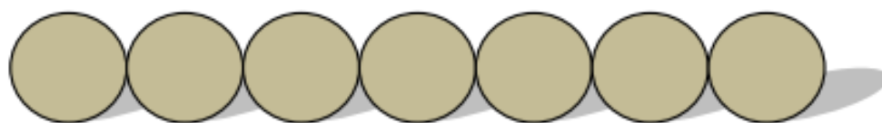
ภาพที่ 12 ดินที่มีขนาดเม็ดสม่ำเสมอ (Uniform Graded)
