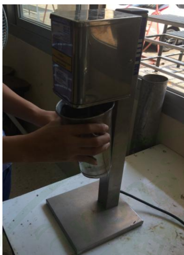
ภาพผนวกที่ ข1 นำเครื่องกวนดินไฟฟ้าปั่นส่วนผสมดิน
