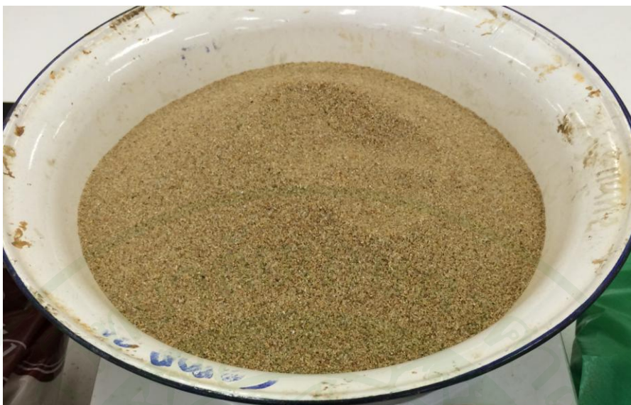
ภาพที่ 26 ทรายตัวอย่างที่มีขนาด D_{50} = 0.49 มิลลิเมตร (A)
