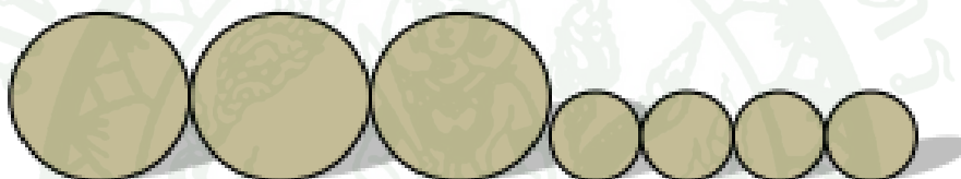
ภาพที่ 13 ดินที่มีขนาดเม็ดขาดช่วง (Skip หรือ Gap Graded)
