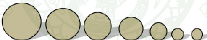
ภาพที่ 11 ดินที่มีขนาดคละกัันดี (Well Graded Soil)
