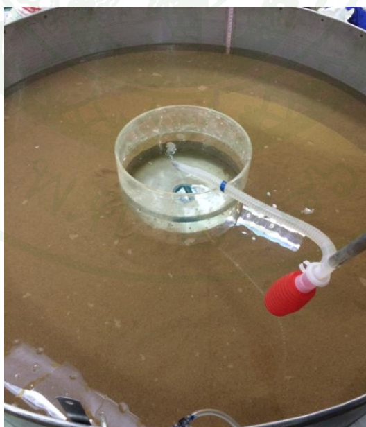
ภาพที่ 33 ปล่อน้ำในอัตราการไหลที่คงที่
