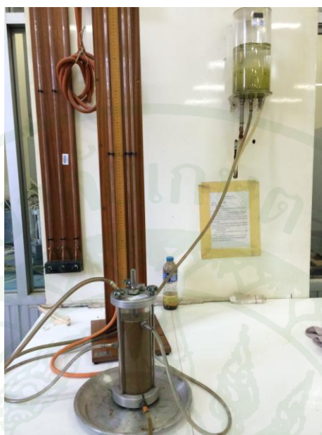
ภาพผนวกที่ ค5 การติดตั้งอุปกรณ์ทั้งหมดเพื่อหาค่าความชื้นน้ำ
