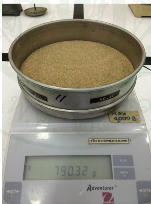
ภาพผนวกที่ ก2 การชั่งหาน้ำหนักทรายแห้งหลังจากเข้าเครื่องเขย่าตะแกรง
