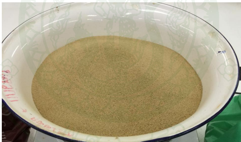
ภาพที่ 27 ทรายตัวอย่างที่มีขนาด D_{50} = 0.30 มิลลิเมตร (B)
