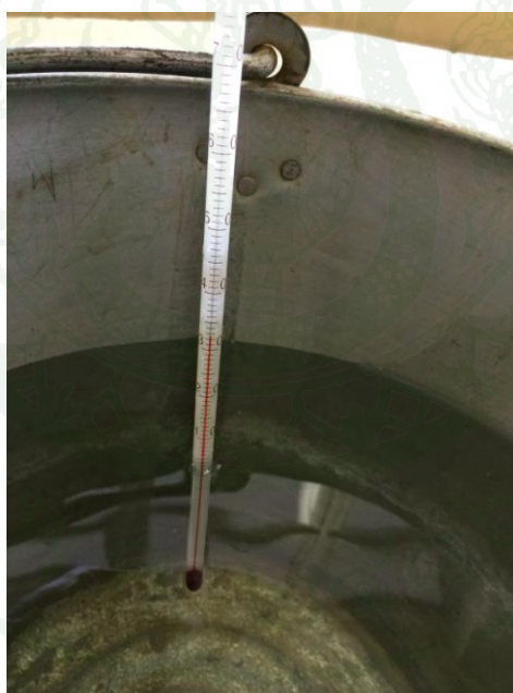
ภาพผนวกที่ ค7 วัดอุณหภูมิของน้ำที่ไหลผ่านเมมเบรน
