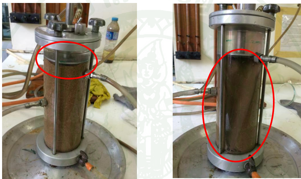
ภาพที่ 23 ความคลาดเคลื่อนด้วยวิธีทดสอบความกดดันคงที่
