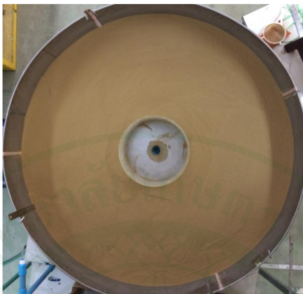
ภาพที่ 32 เทตัวอย่างทรายให้มีระดับ 5 และ 10 เซนติเมตร
