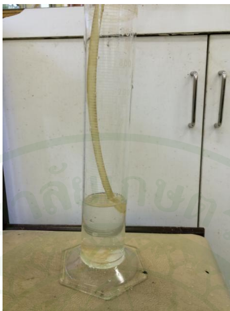
ภาพผนวกที่ ค6 การวัดอัตราการไหลของน้ำที่ไหลซึมผ่านเมมเบรน
