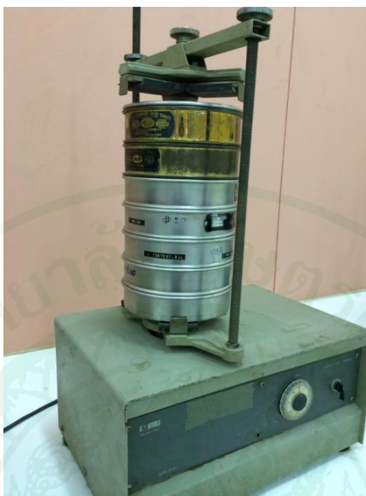
ภาพผนวกที่ ก1 เครื่องเขย่าตะแกรงที่ใช้ในการทดสอบ
