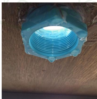
ภาพที่ 29 เจาะรูตรงกลางถาดทดลองเพื่อให้ น้ำและเม็ดทรายระบายลงมา
