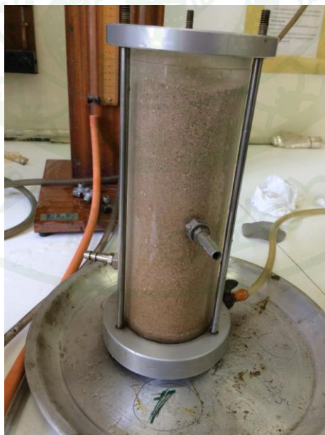
ภาพผนวกที่ ค4 การติดตั้งโมลในการทดสอบค่าความชื้นน้ำ
