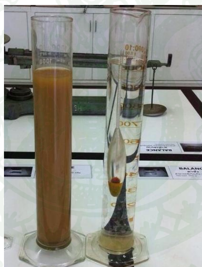
ภาพผนวกที่ ข4 หลังจากเสร็จการอ่านค่า นำไฮโดรมิเตอร์จุ่มไว้ในกระบอกน้ำเปล่า เพื่อที่จะนำไปวัดที่เวลาต่างๆต่อไป
