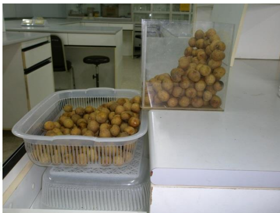
ภาพที่ 9 การทดลองมุมกองพื้นของวัสดุแบบแบบถ่ายเท (Emptying)
