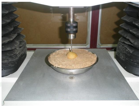
ภาพที่ 13 การกดผลลำไยสดของเครื่อง Texture Analyzer
