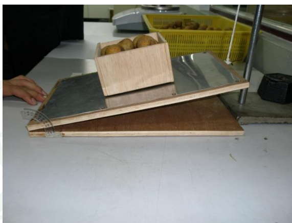
ภาพที่ 10 การทดลองหาสัมประสิทธิ์ความเสียดทานสถิตบนแผ่นพื้นผิวสแตนเลส
