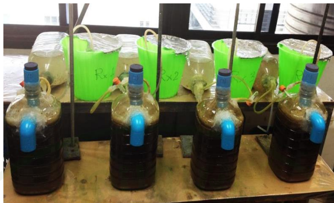
ภาพที่ 8 ถังหมักและระบบเก็บก๊าซที่ใช้สำหรับการทดลอง
