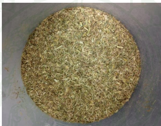
ภาพที่ 9 ฟางข้าวบดละเอียดผ่านตะแกรงขนาด 2 mm
