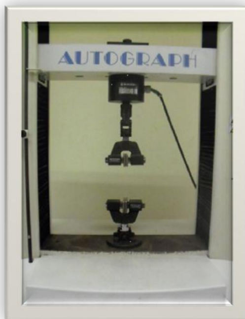
รูปที่ 3.10 เครื่องทดสอบด้านทานแรงดึง Universal Testing รุ่น Autograph AG-I
