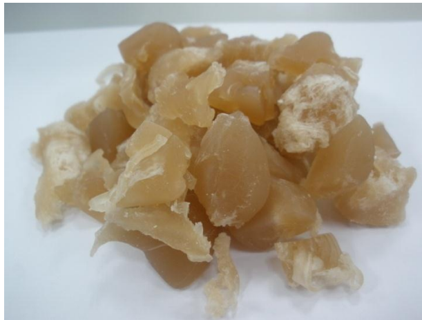
รูปที่ 4.2 ลักษณะของ TPS ที่ได้จากการผสมด้วยเครื่องผสมระบบปิด
