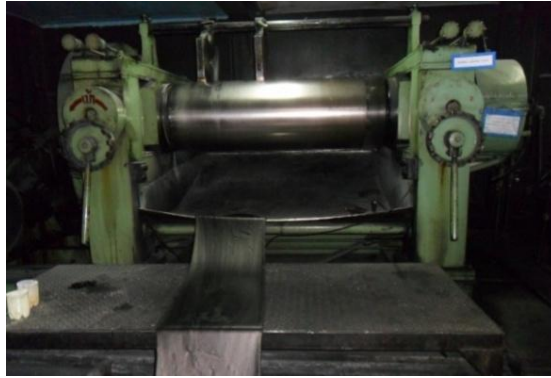
รูปที่ 3.2 เครื่องรีดแบบ 2 ลูกกลิ้งที่โรงงานยาง อุทธารเรือธนบุรี
