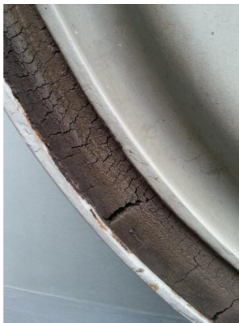
รูปที่ 1.2 รอยแตกที่พบได้ทั่วไปบนยางขอบประตูลูเรือ
