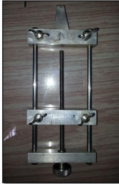
รูปที่ 3.17 เครื่องสำหรับจับยึดและดึงยึดขึ้นทดสอบ ในการทดสอบความทนทานต่อไอโซน
