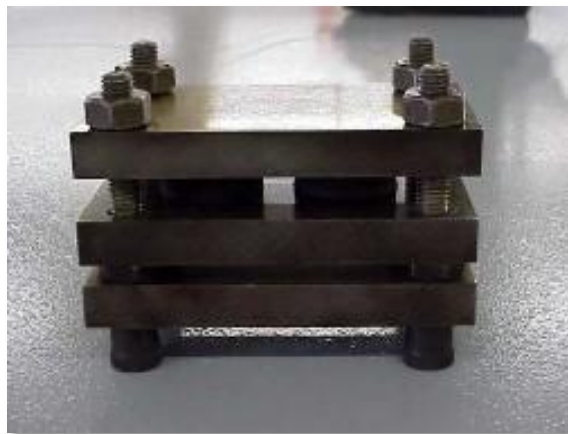
รูปที่ 3.12 เครื่องทดสอบการเสียรูปถาวรหลังการกด
