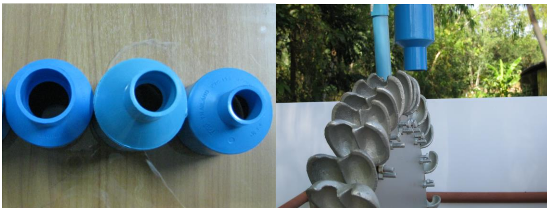
รูปที่ 3.17 ขนาดของหัวฉีดที่ใช้ทดสอบหาแรงกระทำต่อก้นหั่น
