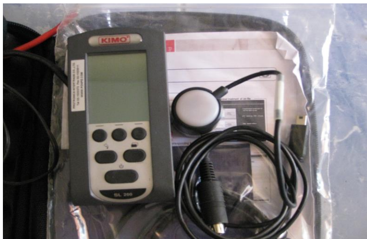
รูปที่ 3.8 เครื่องวัดพลังงานแสงอาทิตย์ (Solar power meter)
