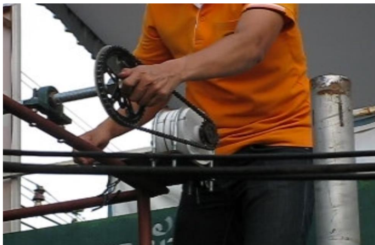
รูปที่ 3.21 ติดตั้งชุดกั้นหั่นเข้ากับเครื่องกำเนิดไฟฟ้า
