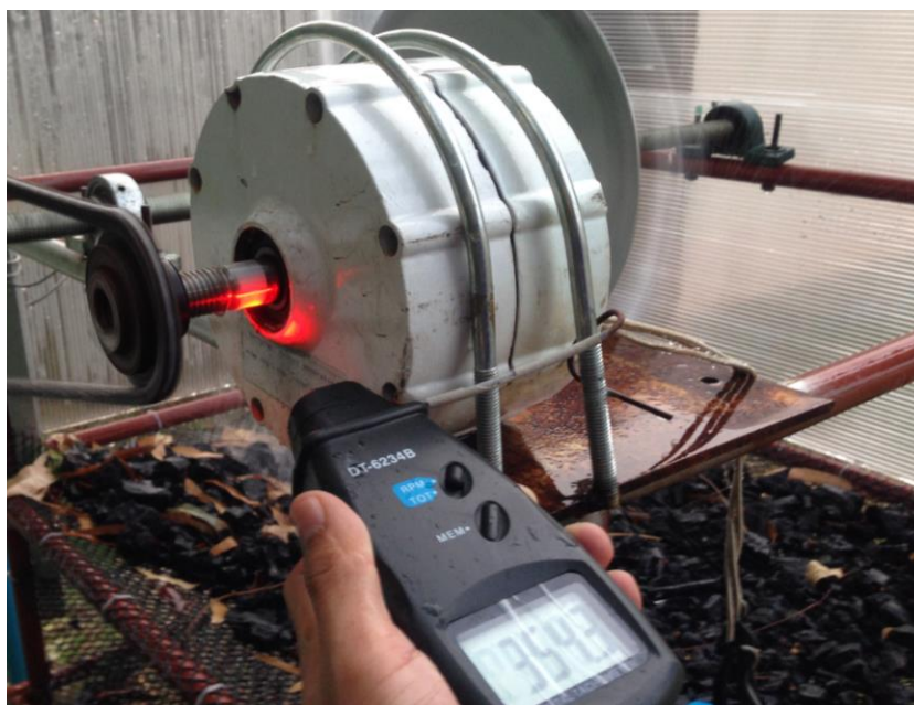
รูปที่ 3.27 เก็บข้อมูลความเร็วรอบ ของเครื่องกำเนิดไฟฟ้า
