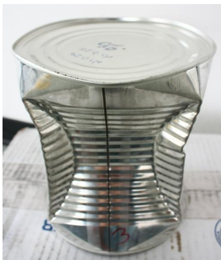
รูปที่ 3.3 พฤติกรรมการเสียหายแบบการโก่งเดาะของกระป๋องบรรจุอาหารชนิด 603×700 เมื่อได้รับความดันสุญญากาศ
