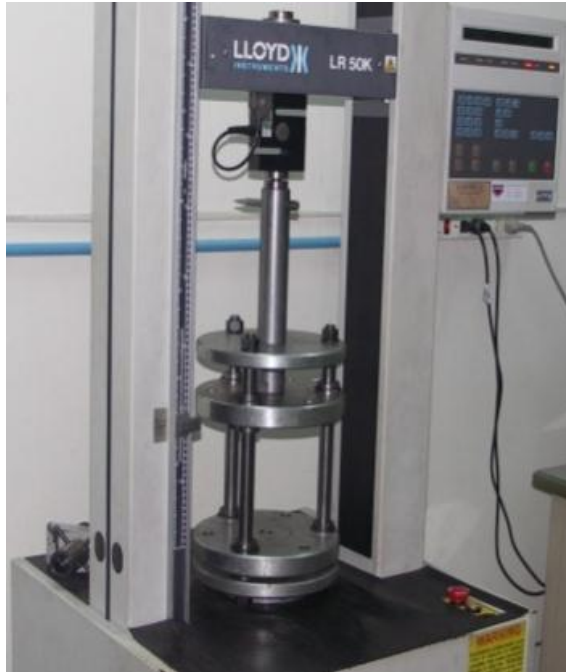
รูปที่ 3.6 การประกอบอุปกรณ์ยึดจับสำหรับการทดสอบภาระกดในแนวแกนเข้ากับ Universal Testing Machine สำหรับทดสอบ
