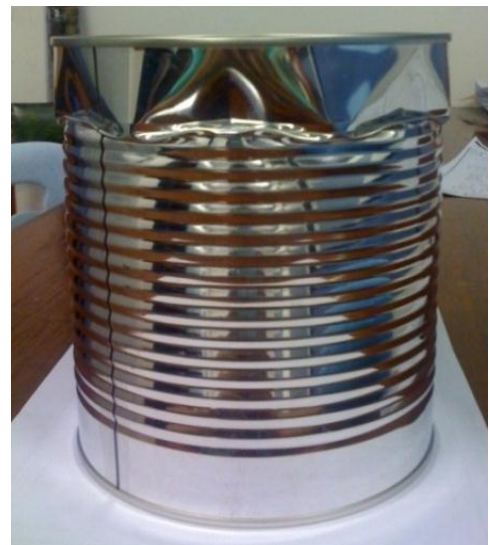
รูปที่ 4.7 การเลือกรูปของกระป๋องจากการรับแรงในแนวแกนแบบ Riks
