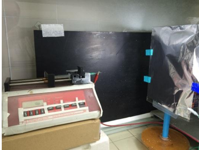
รูปที่ 3.4 การปั่นเส้นใยด้วยไฟฟ้าสถิตโดยใช้แผ่นอะลูมิเนียมฟอล์ยเป็นอุปกรณ์รองรับเส้นใย
