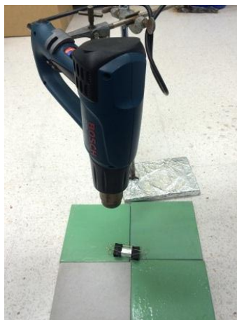
รูปที่ 3.11 การผนึกเซลล์โดยใช้เครื่องเป่าลมร้อน
