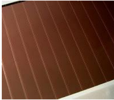
รูปที่ 2.4 เซลล์แสงอาทิตย์จากสารกึ่งตัวนำซิลิคอนที่ไม่เป็นผลึก [29]
