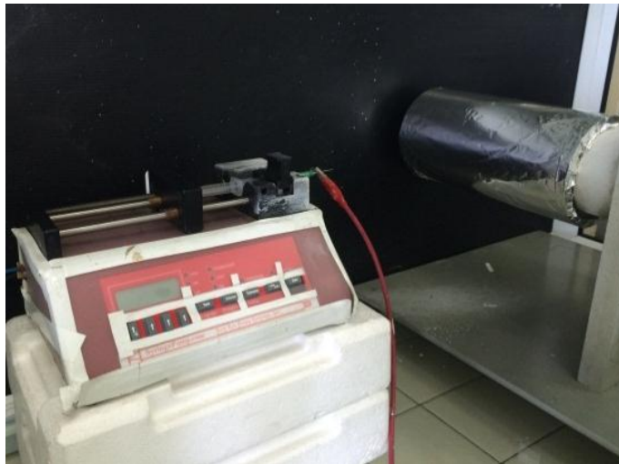
รูปที่ 3.5 การปั่นเส้นใยด้วยไฟฟ้าสถิตโดยใช้วัสดุรองรับแบบโรเตอร์
