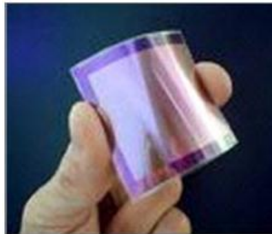
รูปที่ 2.5 เซลล์แสงอาทิตย์แบบฟิล์มบาง [28]
