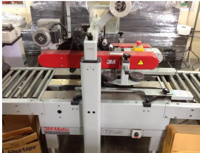
รูปที่ 3.14 กระบวนการปิดปากกล่องลูกฟูกและปิดผนึกด้วยแทปกาว
