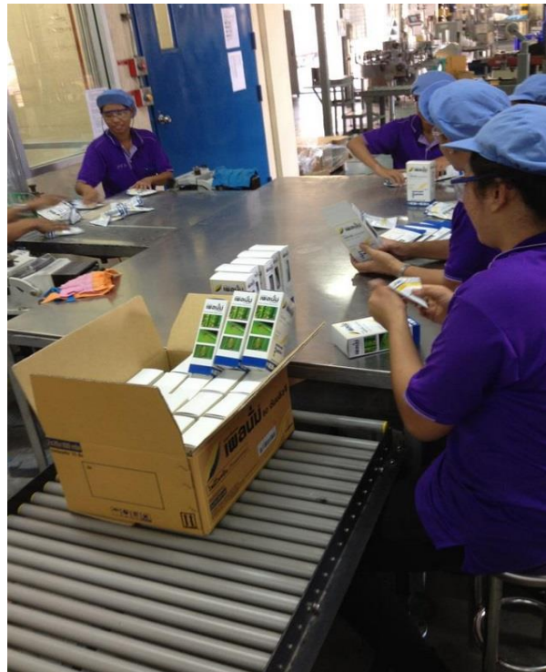
รูปที่ 3.13 กระบวนการบรรจุผลิตภัณฑ์ลงกล่องลูกฟูก
