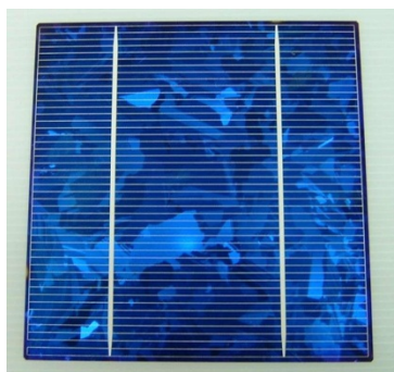
รูปที่ 2.6 เซลล์แสงอาทิตย์ชนิดผลึกมัลติคริสตัลไลน์ซิลิคอน [6]
