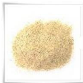
รูปที่ 2.8 สารกรองแอนทราไซด์ (ที่มา : วิทยาลัยลักษณะ สุภอม, พ.ศ. 2551)
