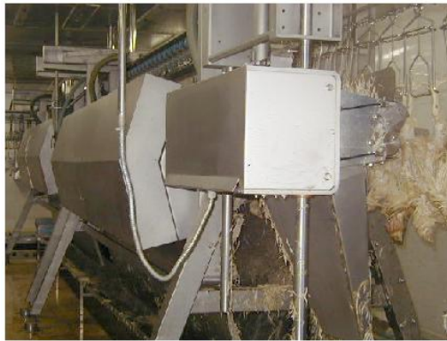
รูปที่ 2.3 กระบวนการถอนขนไก่ (ที่มา : กรมโรงงานอุตสาหกรรม, พ.ศ. 2551)
