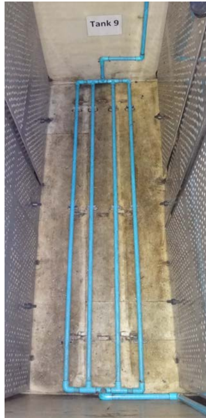
รูป ก.3 ท่อลมระบายความร้อนแบบ 4 เส้น ระยะห่างระหว่างเส้น 25 เซนติเมตร
