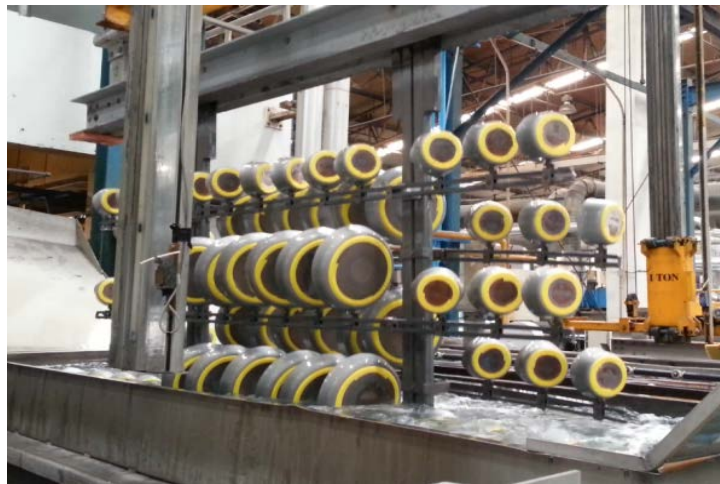
รูปที่ 3.7 ลักษณะการนำชิ้นงานเข้าสู่กระบวนการ Hard anodized
