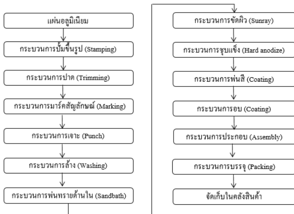
รูปที่ 3.1 กระบวนการผลิตชิ้นงาน
