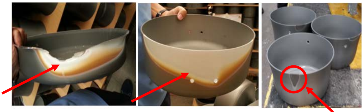
รูปที่ 3.8 ลักษณะการไหม้ของชิ้นงานจากกระบวนการ Hard anodized
