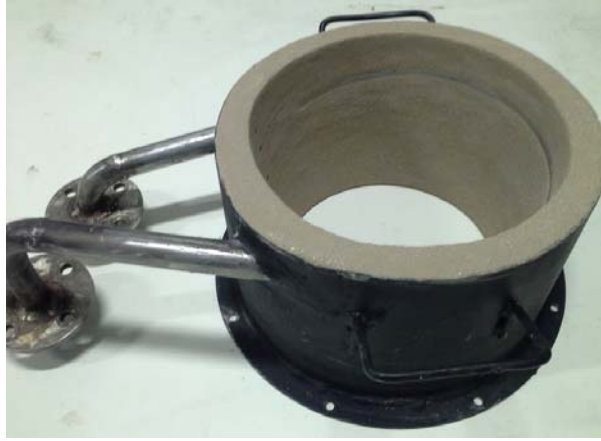
รูปที่ ก.4 ปูนทนไฟที่หล่อเป็น Taper อยู่ด้านในห้องเผาไหม้
