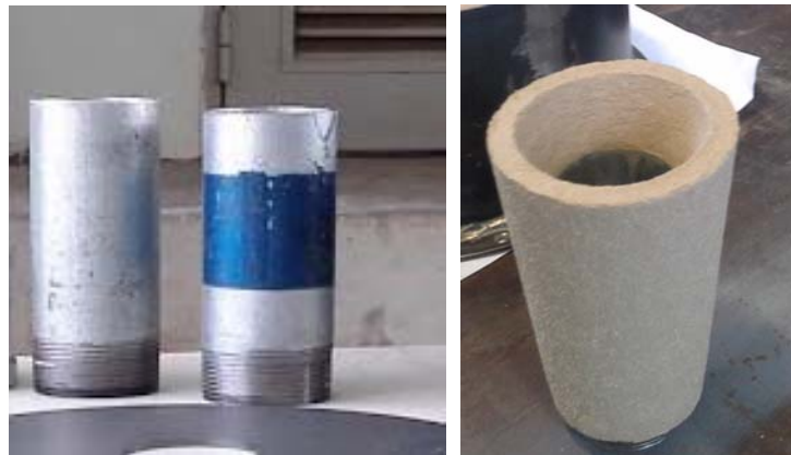
รูปที่ ก.2 แกนกลางของท่อ Secondary air inlet
