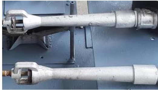
รูปที่ ก.7 Mixing tube
