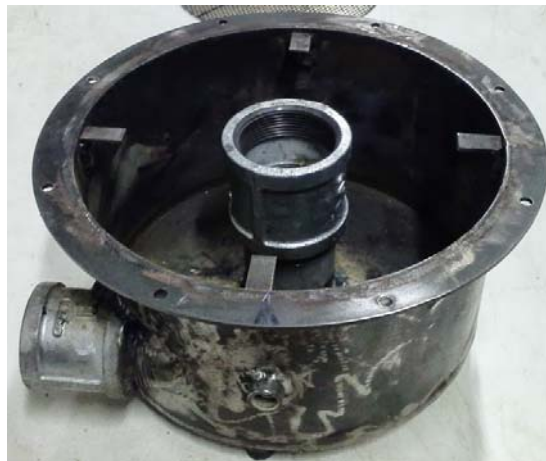
รูปที่ ก.6 Mixing chamber
