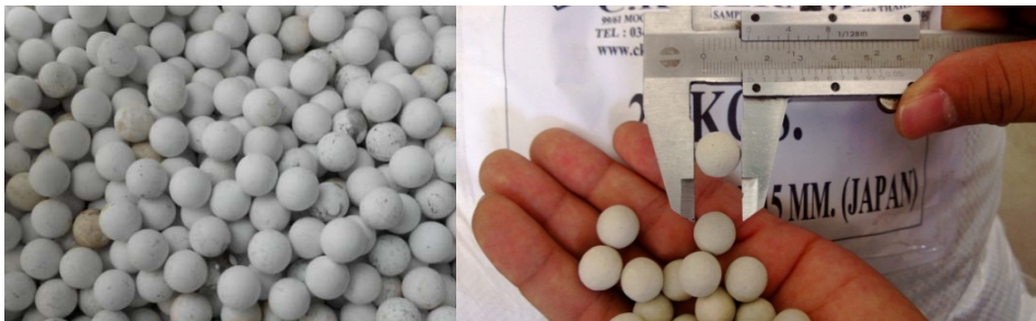
รูปที่ 3.2 วัสดุพรุนอะลูมินาออกไซด์ ( Al_2O_3 )
