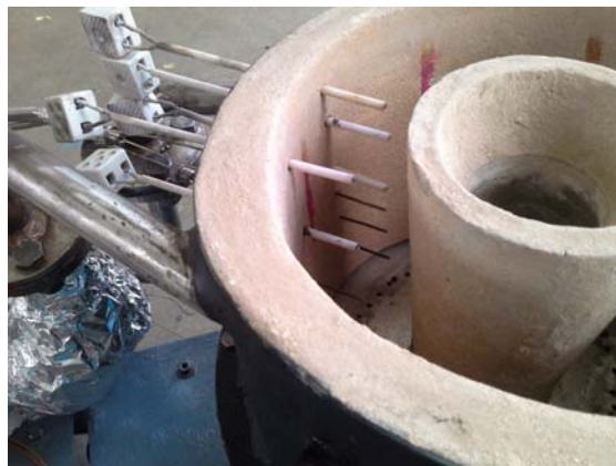
รูปที่ ก.16 ตำแหน่งการติดตั้ง Thermocouple
