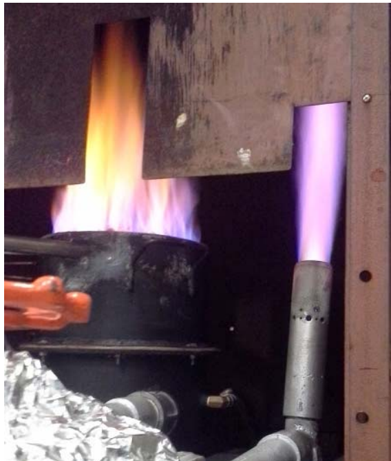
รูปที่ 5.5 ทดสอบการระเหยของเอทานอลที่ Bypass burner
