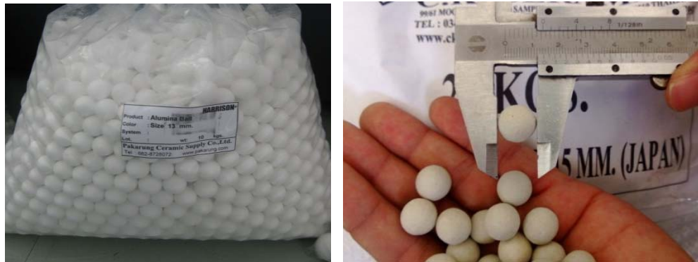
รูปที่ ก.1 Porous Medium, PM ใช้ในเตา SLAPB
