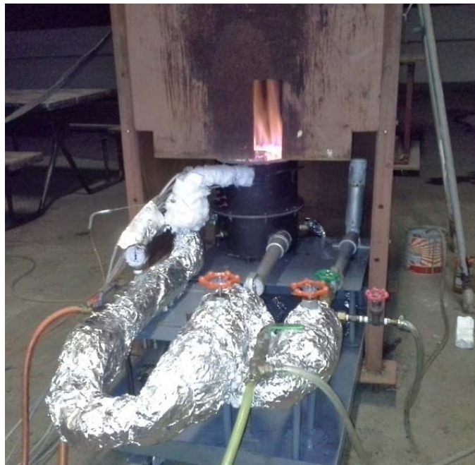
รูปที่ 5.8 Switch Ethanol เข้าไปใน Porous burner
