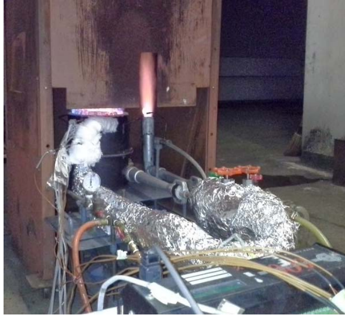
รูปที่ 5.7 ทดสอบการระเหยของเอทานอลที่ Auxiliary burner
