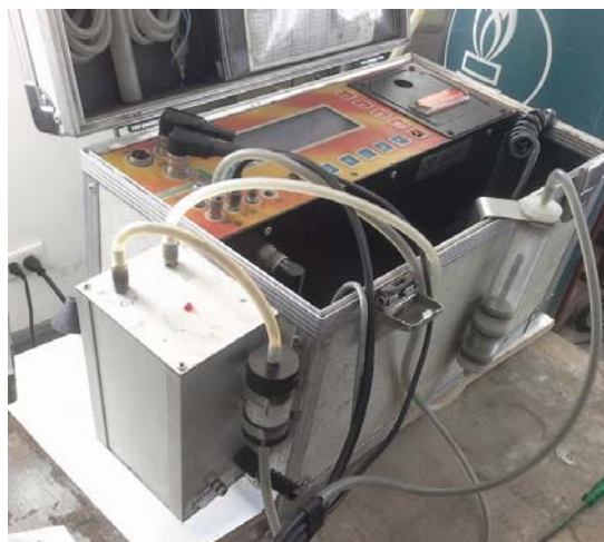
รูปที่ ก.18 อุปกรณ์วัดไอเสีย (Exhaust Analyzer)
