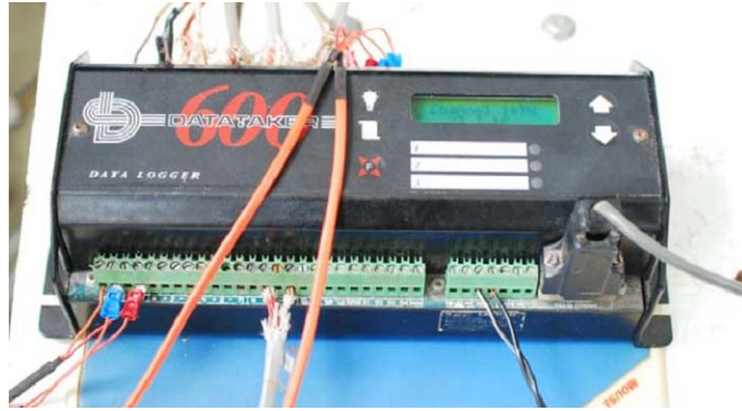
รูปที่ ก.17 Thermocouple Recorder
