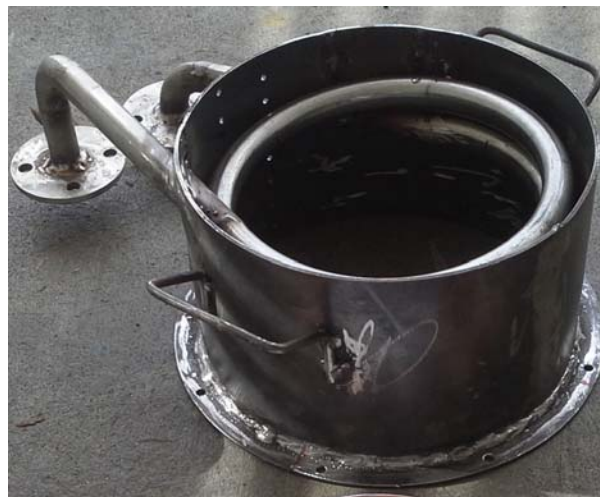
รูปที่ ก.3 ท่อระเหยเชื้อเพลิงเหลวที่ฝังอยู่ด้านในห้องเผาไหม้
