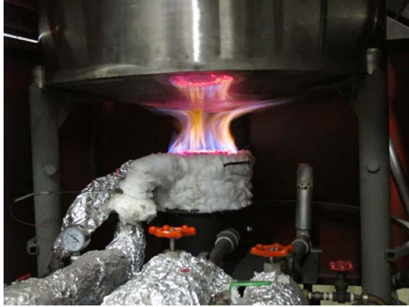
รูปที่ 5.11 ก้นหม้อหัวเผาที่ความสูง 125 mm.
