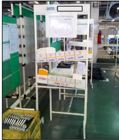
รูปที่ 4.38 ผลการจัดทำชั้นวางชิ้นงานย่อย และสินค้าคงคลัง
