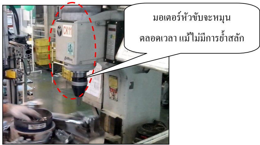
รูปที่ 4.15 แนวทางการดำเนินการเครื่องย้าสตั๊กไม่ให้เดินเครื่องเปล่า
