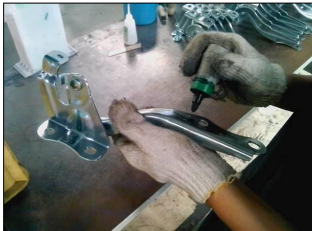
รูปที่ 4.21 การตรวจเช็คชิ้นงานโดยมาร์คสีหลังขั้นตอนการตัด
