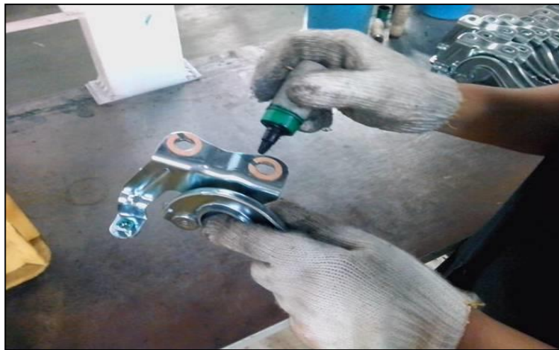
รูปที่ 4.23 การตรวจเช็คชิ้นงาน โดยมาร์คสี หลังขั้นตอนติดแผ่นรอง
