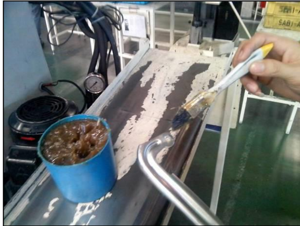
รูปที่ 4.17 ก่อนดำเนินการ พนักงานจะใช้แปรงทาจาระบีที่ชิ้นงาน
