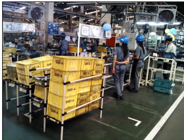
รูปที่ 4.39 ผลการติดตั้งเครื่องมืออุปกรณ์ในการเดินระบบคัมบัง
