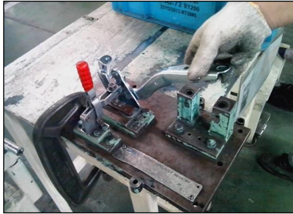
รูปที่ 4.20 ผลการดำเนินการจัดทำอุปกรณ์จับยึดชิ้นงานช่วยในการตัด
