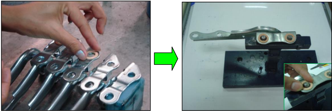
รูปที่ 4.22 ผลดำเนินการแก้ไขจัดทำอุปกรณ์จับยึดช่วยการในการติดแผ่นรอง
