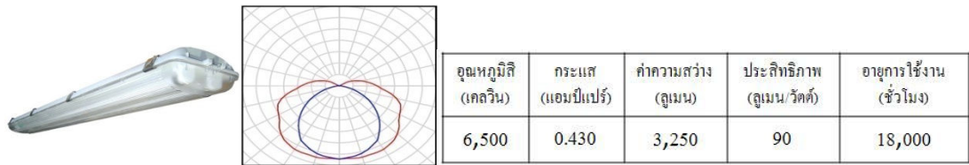
รูปที่ 3.4 ลักษณะโคมไฟชนิด F2
