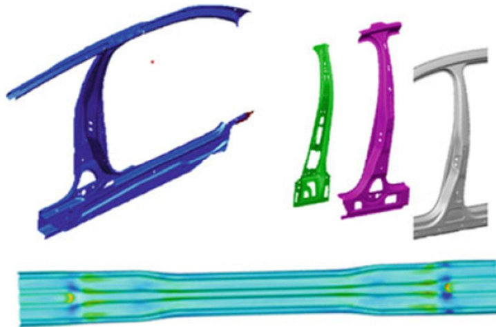
รูปที่ 2.8 ตัวอย่างชิ้นงานที่ใช้กระบวนการขึ้นรูปร้อนแบบตรง [13]
