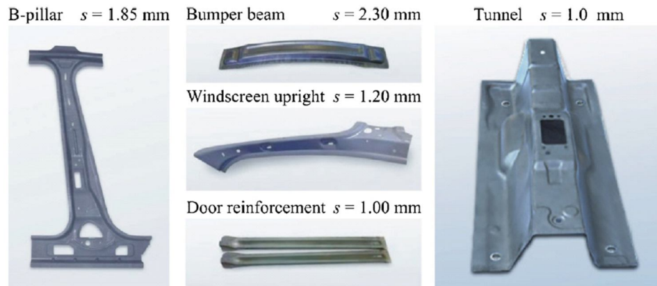
รูปที่ 2.5 ความหนาของเหล็กกล้าความแข็งแรงสูงพิเศษที่ใช้ในชิ้นส่วนต่างๆ [11]
