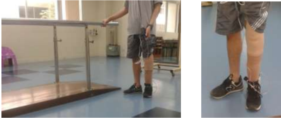
รูปที่ 4.12 การทดสอบเซ็นเซอร์วัดแรงกด และแรงเฉือนใช้กับผู้พิการ
